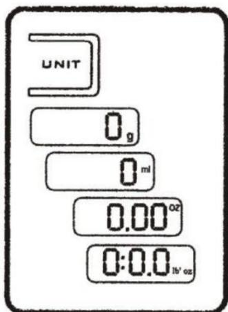
Эти весы разработаны с 2-мя системами измерения: метрическая система и британская система, между которыми можно переключаться, нажимая кнопку UNIT.
