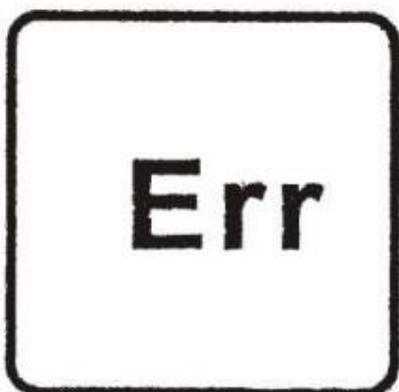
Когда появляется индикатор перегрузки во время взвешивания, это означает, что текущий вес превышает максимальную нагрузку весов. Незамедлительно уберите предмет с весов, чтобы избежать повреждение весов.
